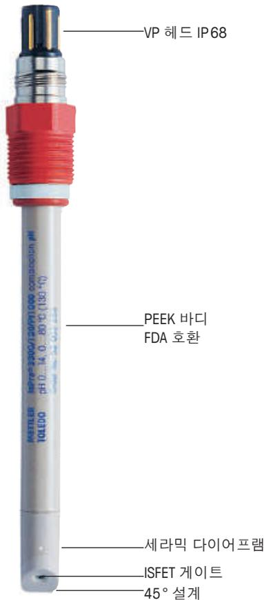
InPro 3300은 ISFET (Ion Selective Field Effect Transistor) 기술을 활용한 solid-state 비유리 pH 센서입니다. 파손 방지 설계로 인해 유리 파손 위험이 없으므로 이 센서는 식품료 산업에 가장 적합합니다. ISFET와 Ingold의 Argenthal 기준 시스템이 결합되어 있는 이 센서는 멸균과정을 수 차례 반복한 후에도 정확한 결과를 제공할 수 있도록 설계되었습니다. 온라인 pH 측정이 사용되므로 자동화된 공정 제어가 가능하고 비용과 시간이 많이 드는 시료 채취 분석이 필요하지 않습니다.
